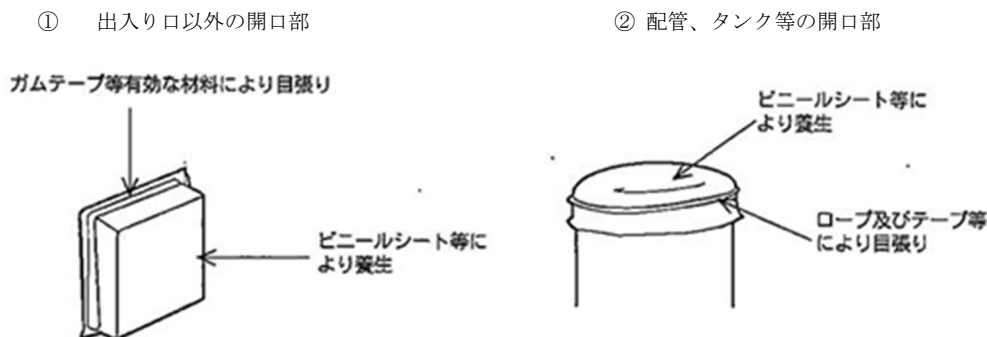
図 4-4 設備開口部の養生
