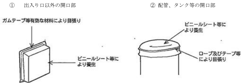
図 4-4 設備開口部の養生
