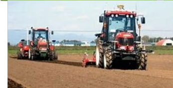
衛星測位情報を用いた自動運転 により作業時間を4割削減
