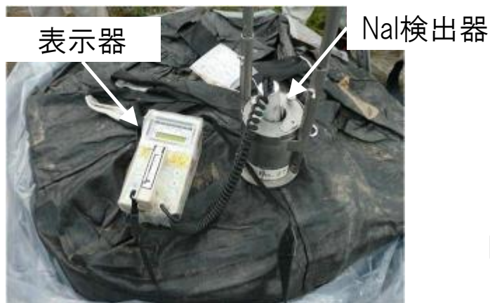
容器表面の放射線量率の測定例
