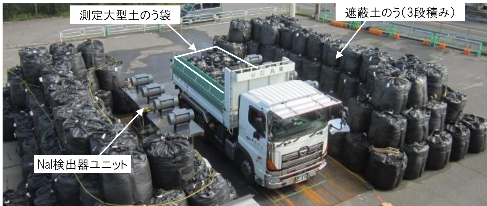
TRUCKSCANによる放射能濃度測定状況
