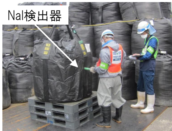
簡易測定法による測定状況
