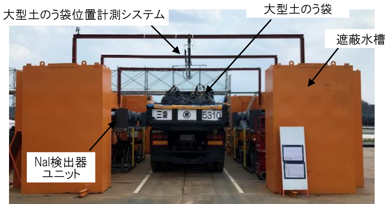
TRUCKSCANによる測定状況
