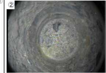
地点No.25のボアホールカメラ画像 (粘土を含む層を検出)
