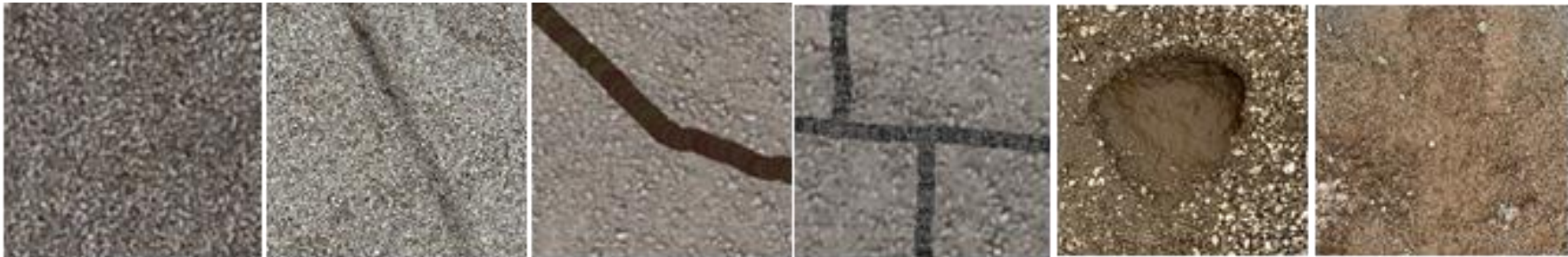
クラス0 (異常なし) クラス1 (直線亀裂) クラス2 (分岐亀裂) クラス3 (垂直分岐亀裂) クラス4 (穴・陥没) クラス5 (押出・浸み出し)
