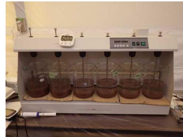
溶媒の液固比と攪拌時間の試験状況
