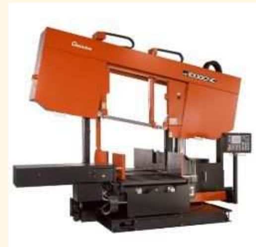
写真 大型コンデンサー用容器裁断装置
