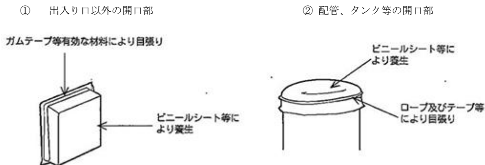
図 4-4 設備開口部の養生
