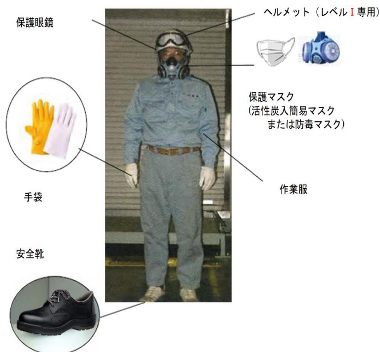
図 4-3 低濃度 PCB 処理施設(プラント設備)解体・撤去工事(解体撤去管理レベル I)の保護具の例
