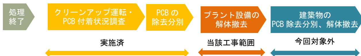
図 2 低濃度 PCB 処理施設の解体撤去フロー
