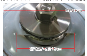
破損したダイヤフラム
