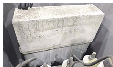
コンクリート固化物
