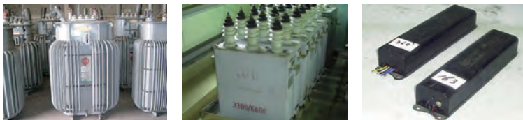
■主な処理対象物：左から、PCB廃棄物となったトランス、コンデンサー、安定器
