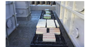
コンクリート供試体屋外暴露 仮設構造物等の外観
