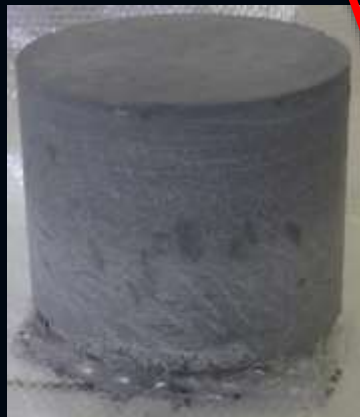
脱型後の20L試験体
