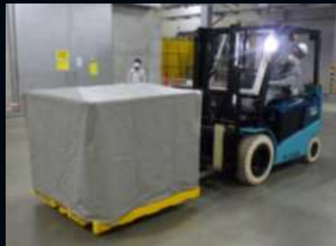
溶融飛灰の鋼製容器搬送状況(処理施設内)
