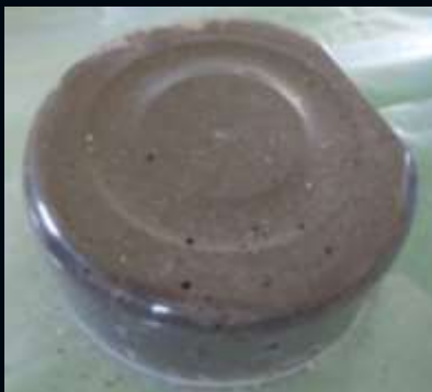
脱型後のジオポリマー固化体の一例
