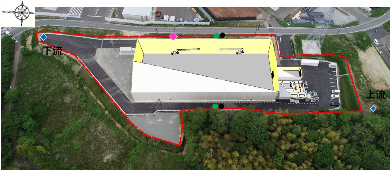
図 2 飛灰洗浄処理技術等実証施設における周辺測定地点
