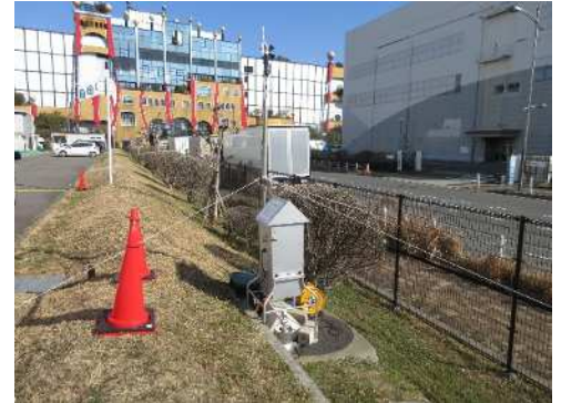
事業所敷地内での測定の様子 (風向・風速計とエアサンプラー)
