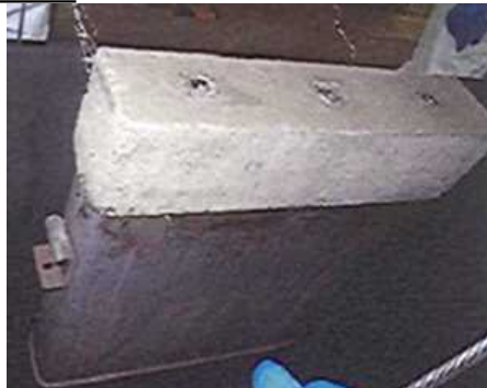
コンデンサーの一部をコンクリートで固化
