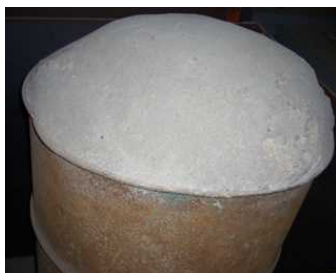
漏洩機器をドラム缶に入れコンクリートで密閉
