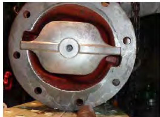
コンプレッサをこのような位置でバルブを組み立てたものと思われる
