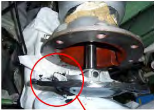
コンプレッサの端が折れ、ダイヤフラムに刺さっている
