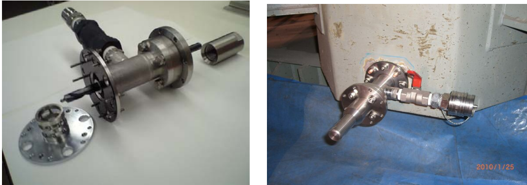
図-3 抜油治具の一例
