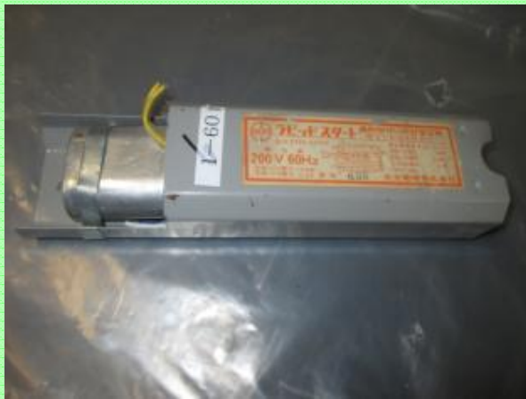
コンデンサ外付け型 安定器
