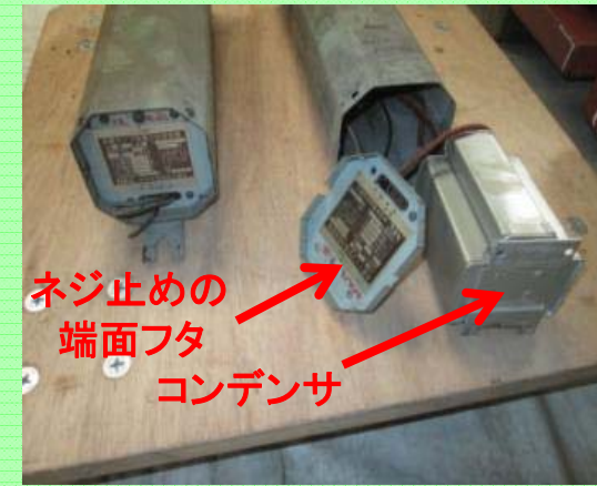
③コンデンサ非露出型 スリットなしタイプ (ネジ止め蓋式(※2))
