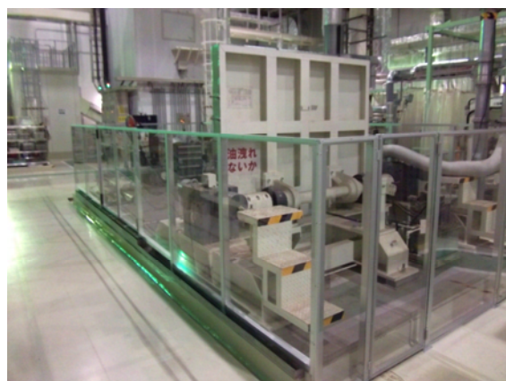
写真5, 6 コア解体室（コア付属品取外し作業場）における囲い取替え（排気も見直し）
