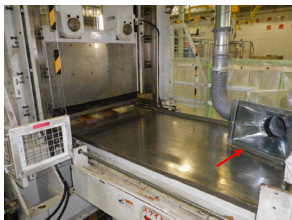
写真7 コイル切断機の排気口の改善 （吸込み口をフード型に変更）
