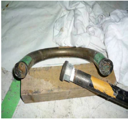
写真1 らせん式冷却器の閉塞状態（H20）
