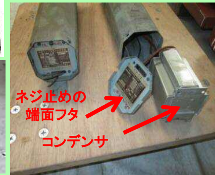
④コンデンサ非露出型 スリットなしタイプ (ネジ止め蓋式(※2))
