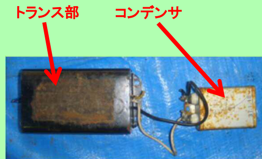
①コンデンサ露出型 タイプ (コンデンサ別置きタイプ)
