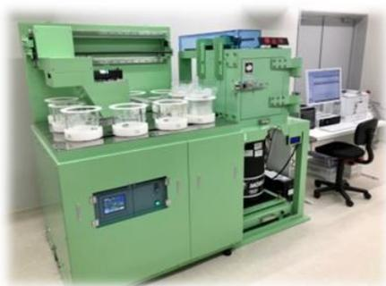
ゲルマニウム半導体検出器により、試料の放射能濃度の測定を行います。
