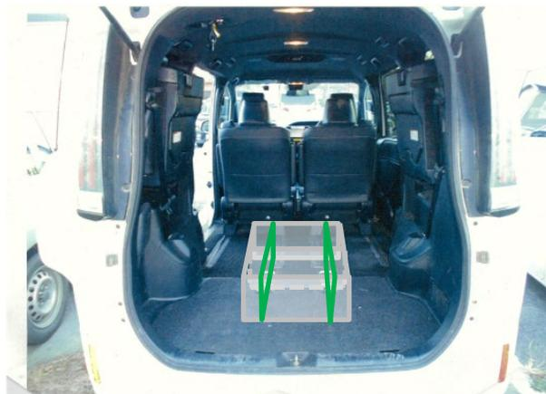
図 2 運搬容器固縛方法
