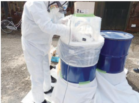
有害物質混入の恐れがある汚泥のサンプリング作業
