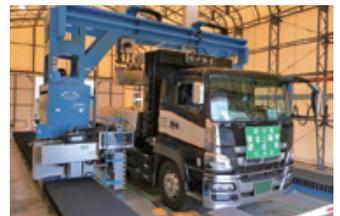
スクリーニングの様子（機械による検査）
