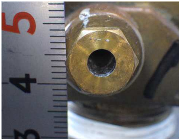
冷媒回収ポンベ 可溶栓が溶解
