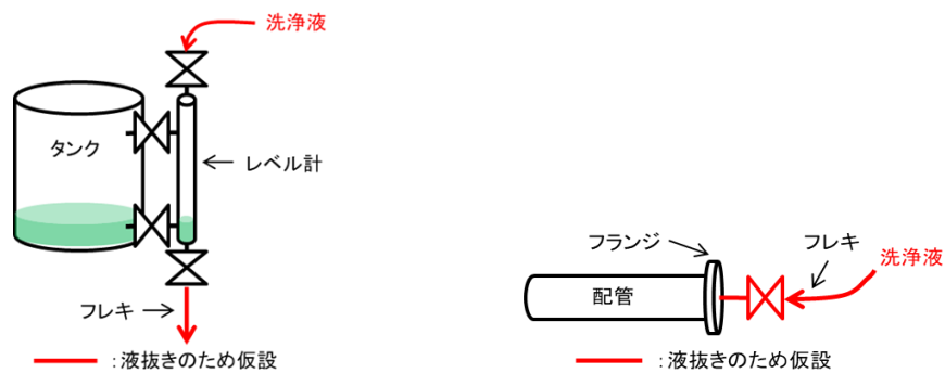
図 2-3 タンクレベル計（左）及び配管末端部（右）の液抜き、洗浄例
