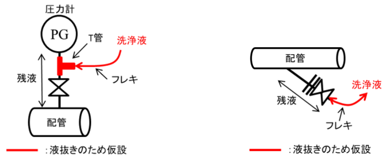
図 2-2 圧力計パイプサイフォン部（左）及び液抜き弁（右）の液抜き、洗浄例
