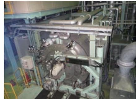
解体撤去前の真空加熱分離装置
