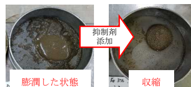
図 2 ふるいを用いた膨潤性確認試験による SAP の膨潤性
