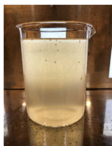
アルカリ凝集処理水
