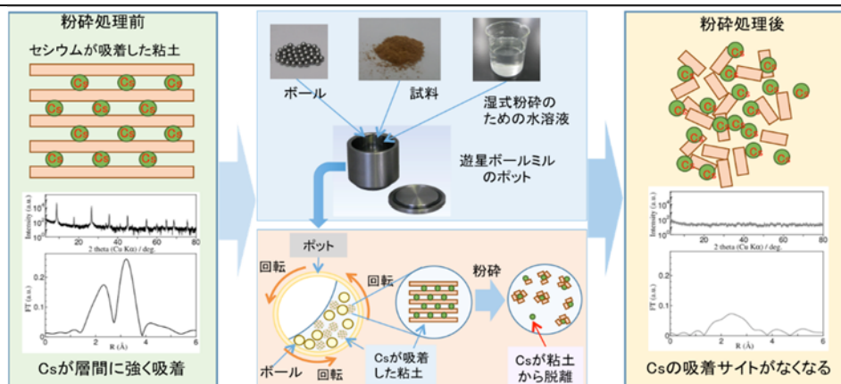
図 2-1 微粉砕処理による Cs 遊離の概略説明図
