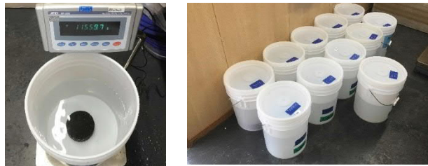
図 2-9 タンクリーチング試験実施状況
