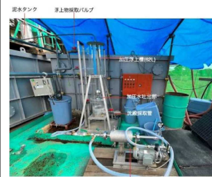
図2 加圧システム、浮上槽（62L）、加圧水供給装置（圧力0.6 MPa2）
