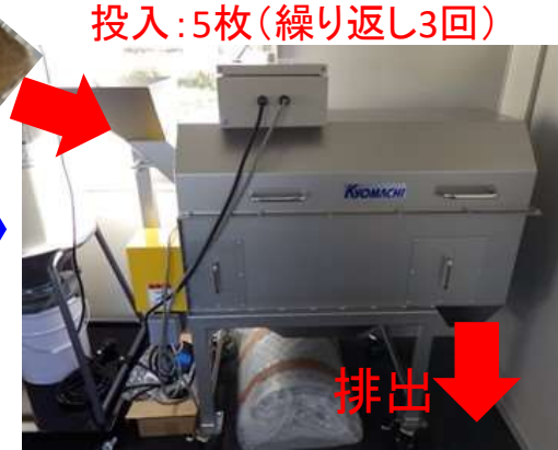
小型トロンメル (Φ400×800L 最大15rpm)
