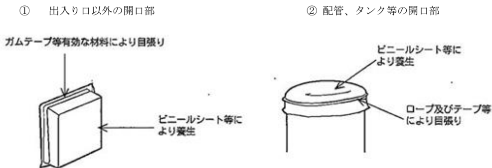
図 4-4 設備開口部の養生
