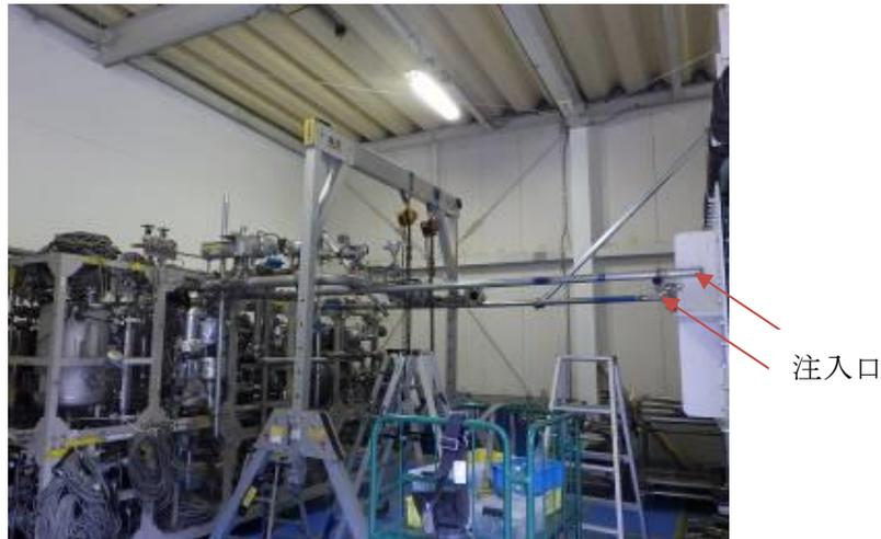
図 2-12 気化溶剤循環抜油で注入口を 2 か所にしたケース
