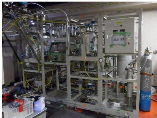
図 2-26 気化溶剤循環抜油
