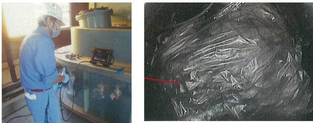
図 2-1 ファイバースコープによる変圧器筐体内部の確認作業
