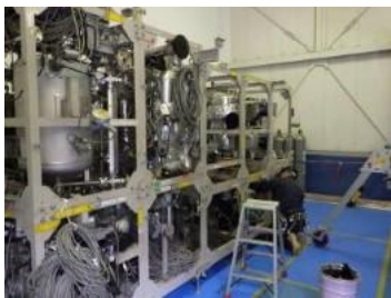
気化溶剤循環抜油装置組み立て
