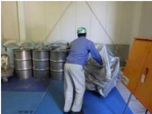
移動式抜油装置による抜油作業。保管事業者により抜油済みとの報告を受けていたが、ファイバースコープによる事前調査の実施により、筐体底部に多量の残油が存在することが判明したため、残油の抜き取り作業を行った。
