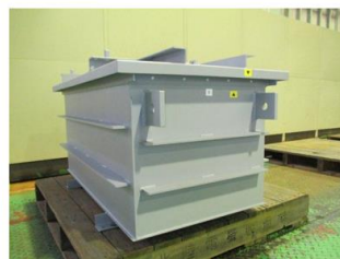
搬出制約をクリアし、かつ 大阪事業所VTR直投可能な サイズの鉄箱を特注
