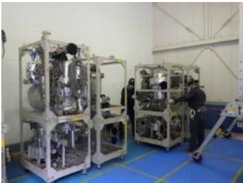
気化溶剤循環抜油装置組み立て
