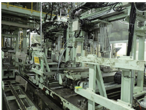
(コンデンサーから自動で素子を押し出す油圧装置を解体撤去しました)
