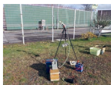
悪臭サンプリング状況 (北海道PCB処理事業所)
