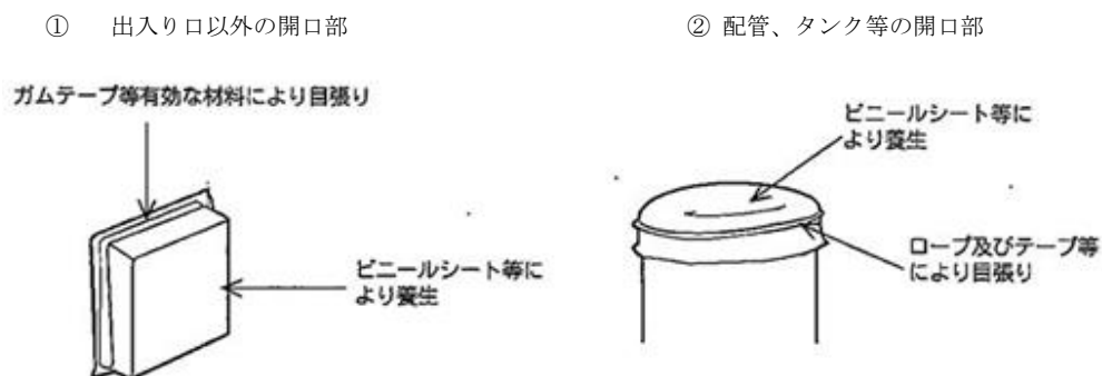
図 4-4 設備開口部の養生
