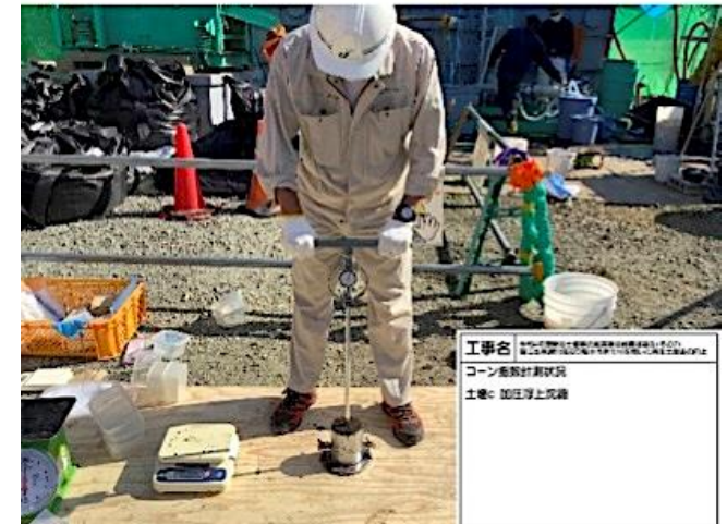
図18 固化試験状況
