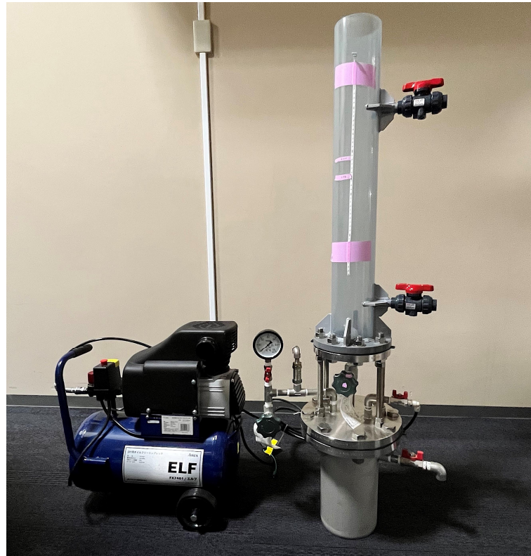
図5 ラボ試験用加圧浮上装置（浮上槽 5L、圧力0.6Mpa max）
