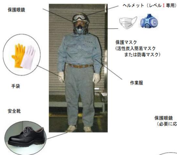
図 9-1 解体撤去管理レベルⅠの保護具の例
