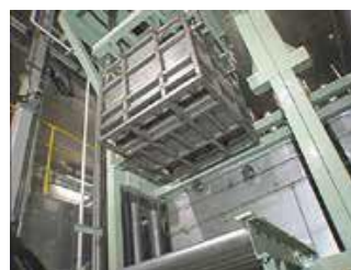
図 19 コンデンサー自動解体ラインの解体撤去物の処理状況 （左：低濃度払出し状況、右：真空超音波洗浄処理（洗いかご））
