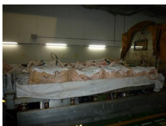
図 19 コンデンサー自動解体ラインの解体撤去物の処理状況 （左：低濃度払出し状況、右：真空超音波洗浄処理（洗いかご））
