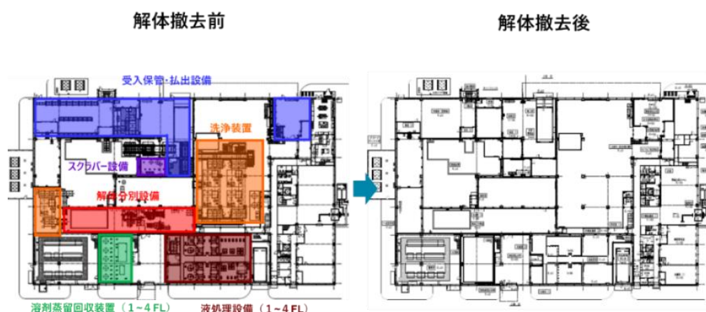
図 7 対象設備(解体撤去の前・後)
