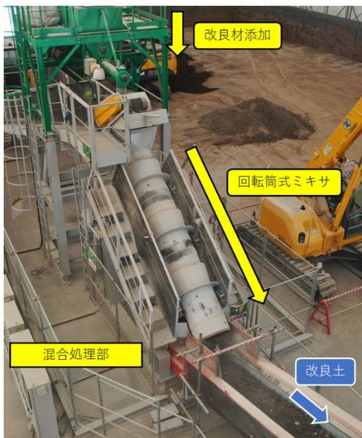
図6(b) SP ミキサの混合処理部
