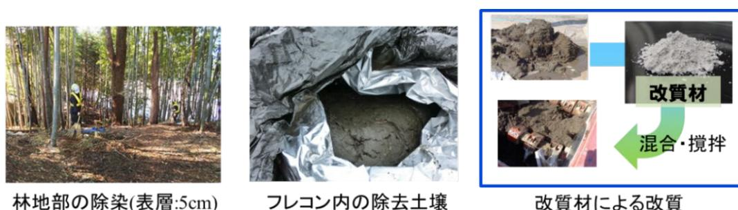
図1 本試験で対象とする有機物含有量が高い除去土壌の概要
