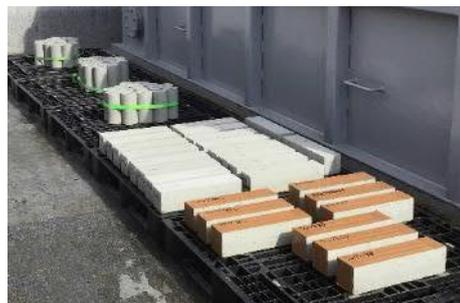
図 2-16 供試体の屋外暴露状況
