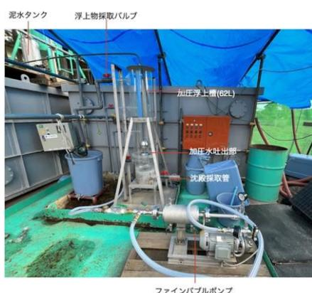
図 3-5 現地試験加圧浮上装置
