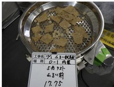
図 4-4 振動ふるい装置 (径 φ500mm 目開 7.266mm)
