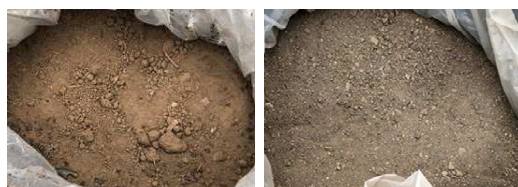
図 左:原土(分別処理土)、中:風選(大)、右:風選(小)
