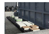
(コンクリート暴露試験)
