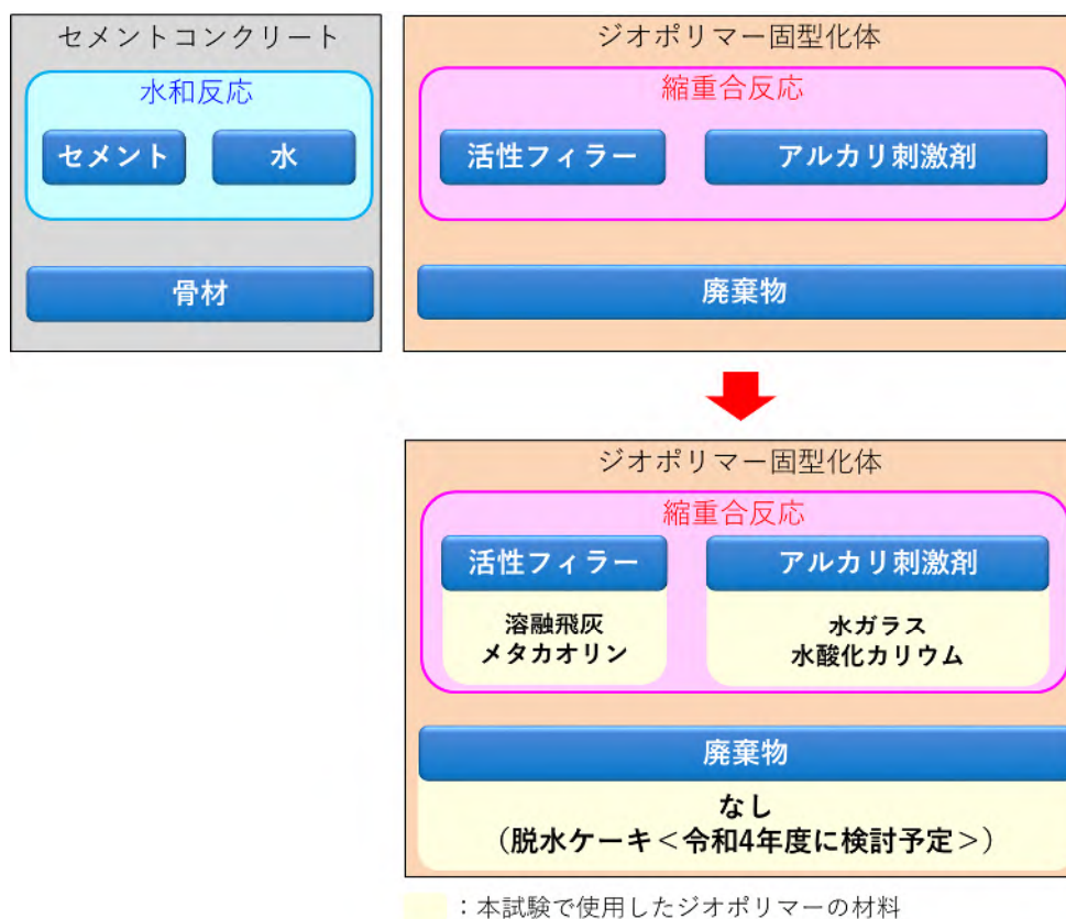
図 2-1 ジオポリマー技術の概略説明図
