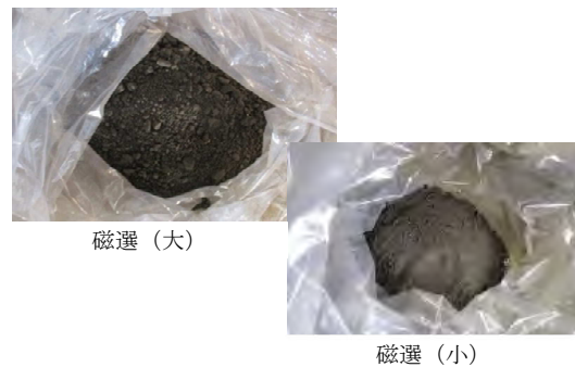
図 3-20 磁力選別の分級状況
