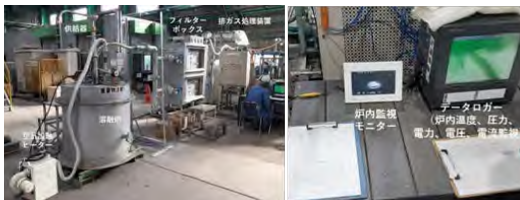
図 3-1 改造後の試験装置（左）及び監視装置（右）
