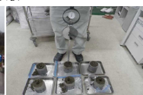
写真-7 室内コーン貫入試験
