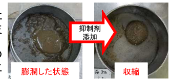
図-1 SAPの吸水膨潤挙動と抑制剤の添加効果(膨潤性確認試験)
