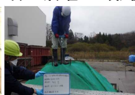
写真-6 原位置コーン貫入試験
