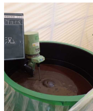
飛灰の洗浄状況
