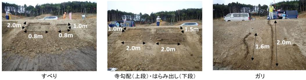
図 1-1 造作した模擬変状例の写真
