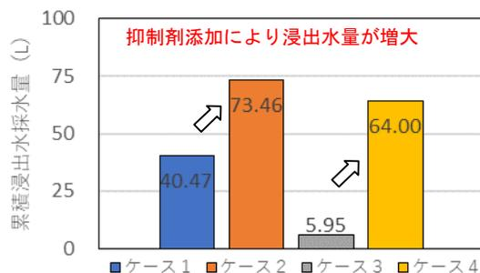
図 3-2 累積浸出水採水量の比較
