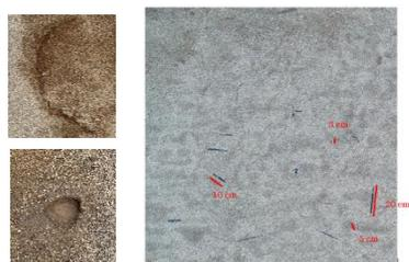
図 3-4 模擬施設で作成した異常識別項目例（亀裂・穴）
