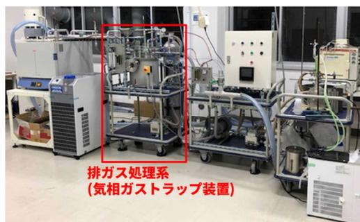
図 2-3 排ガス処理系 (気相ガストラップ装置) を増設した改良版ガラス固化装置
