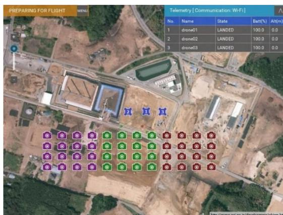
図 3-8 多点連続静止画撮影プロトタイプシステムメイン画面
