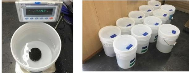
図 2-9 タンクリーチング試験実施状況
