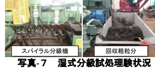
写真-7 湿式分級試験処理状況
