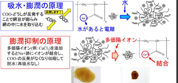
図-2 膨潤抑制剤によるSAPの吸水能力低減原理
