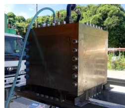
図 2-6 高圧脱水ブロック (400×400×400mm)
