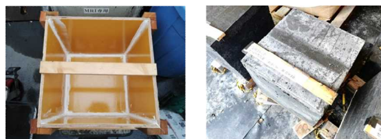
図 2-3 型枠ブロック (400×400×400mm)
