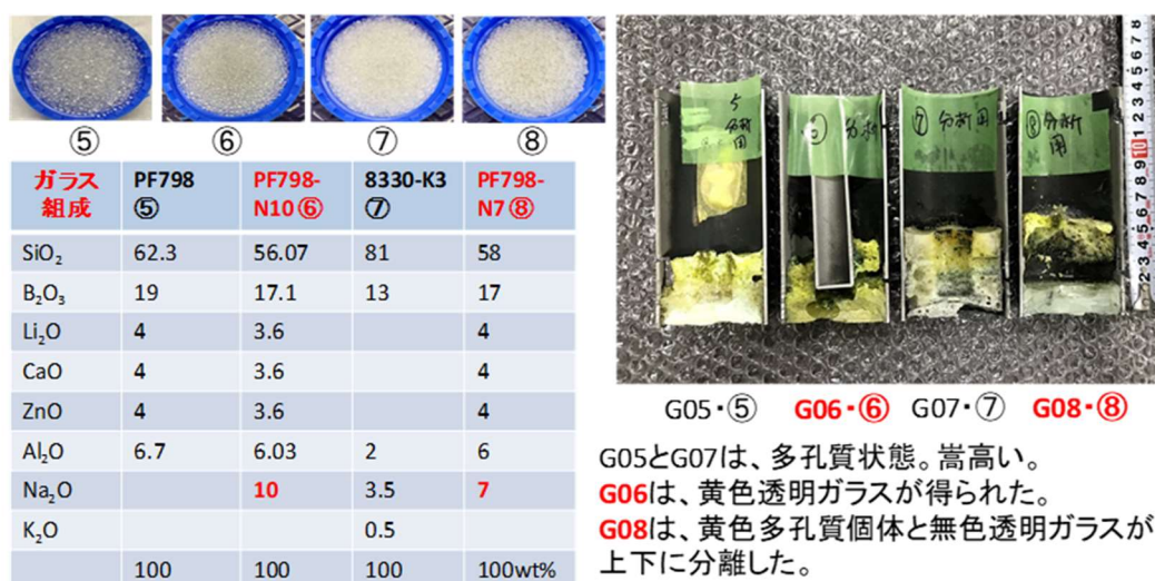
図2-4 ガラス固化体G05～G08の原料ガラスフリットと切断したガラス固化体の写真
