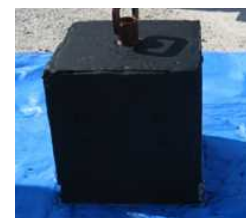
図 2-6 高圧脱水ブロック (400×400×400mm)
