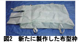
図2 新たに製作した布型枠
