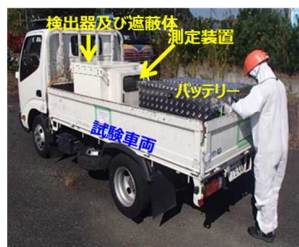
図3 測定装置（トラック搭載）
