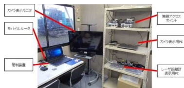
図3 管制システム
